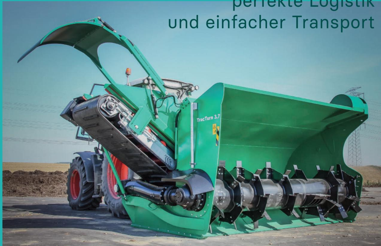
Der TracTurn vereint Auflockern, Mischen und gleichzeitiges Seitenversetzen zu einem Arbeitsgang.
