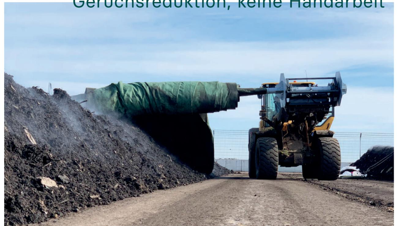
Es gibt mehrere Möglichkeiten, Mieten abzudecken. Die teuerste, aber auch langlebigste Möglichkeit ist ein festes Dach. Alternativ dazu können die Kompostmieten mit einem Textil abgedeckt werden. In diesem Fall wird die Abdeckung direkt auf das Material gelegt. Hier unterscheidet man zwischen einer *Vliesabdeckung* und einer *Membranabdeckung*.
