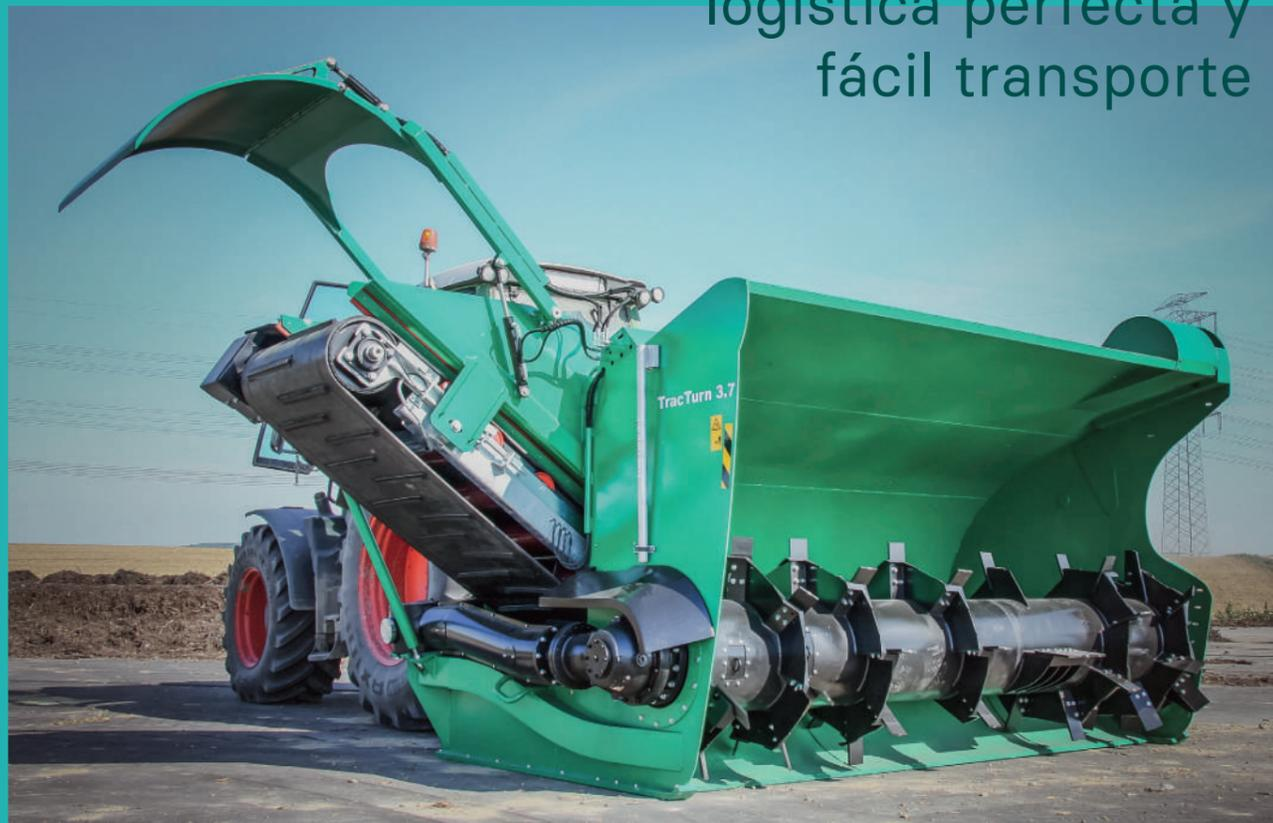
El TracTurn combina en un solo paso la descompactación, la aireación, la mezcla y el apilado lateral del material.
