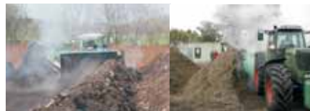
Mit einer Arbeitsbreite von 3,7m schneidet der Trac Turn die beliebig breite Miete auseinander.
