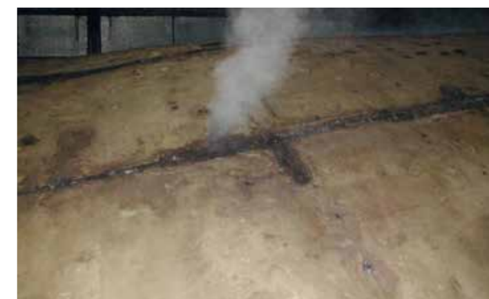
Powietrze procesowe uchodzi przez otwór w membranie.
