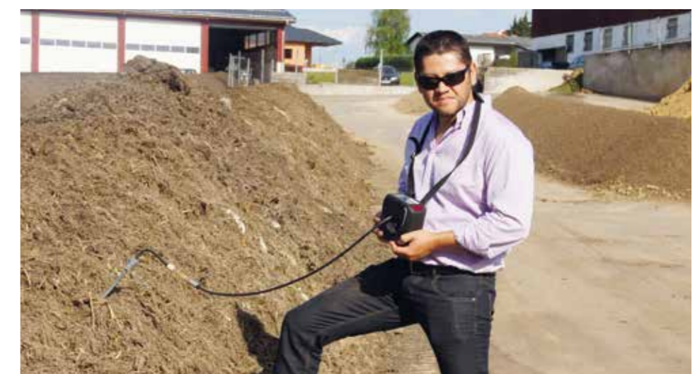
Miernik emisji gazów w przymach pozwala na badanie jednocześnie nawet 5 różnych rodzajów gazu.
