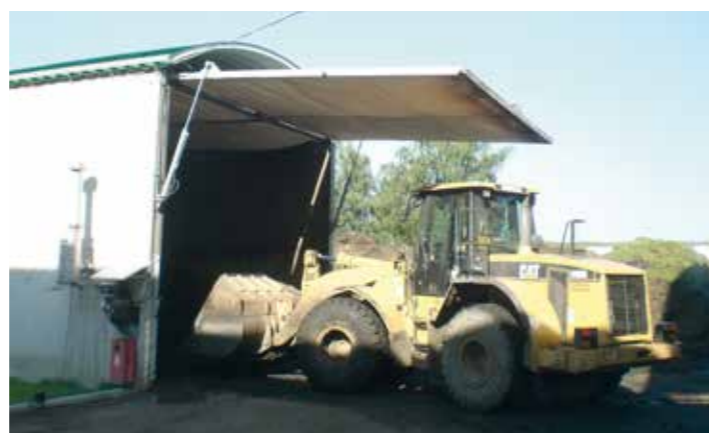
Załadunek i rozładunek boksu bez zdejmowania membrany
