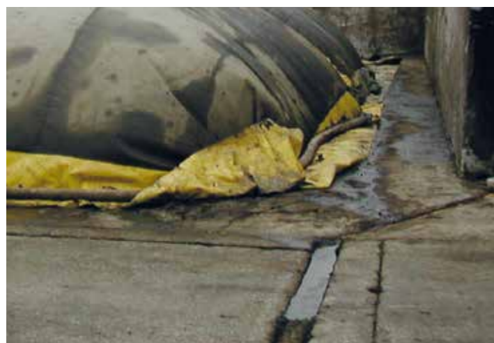
Woda technologiczna może wydobywać się z boku spod membrany. Może ona emitować więcej odorów, niż sama przyzma kompostowa
