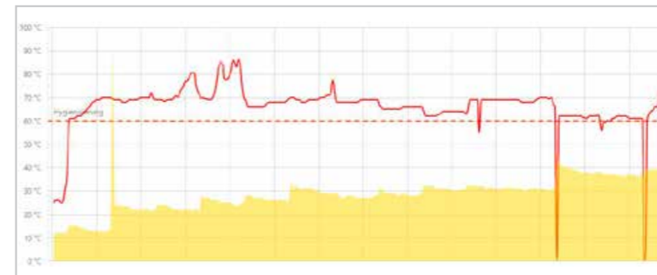
Automatischer Nachweis der Hygienisierung
