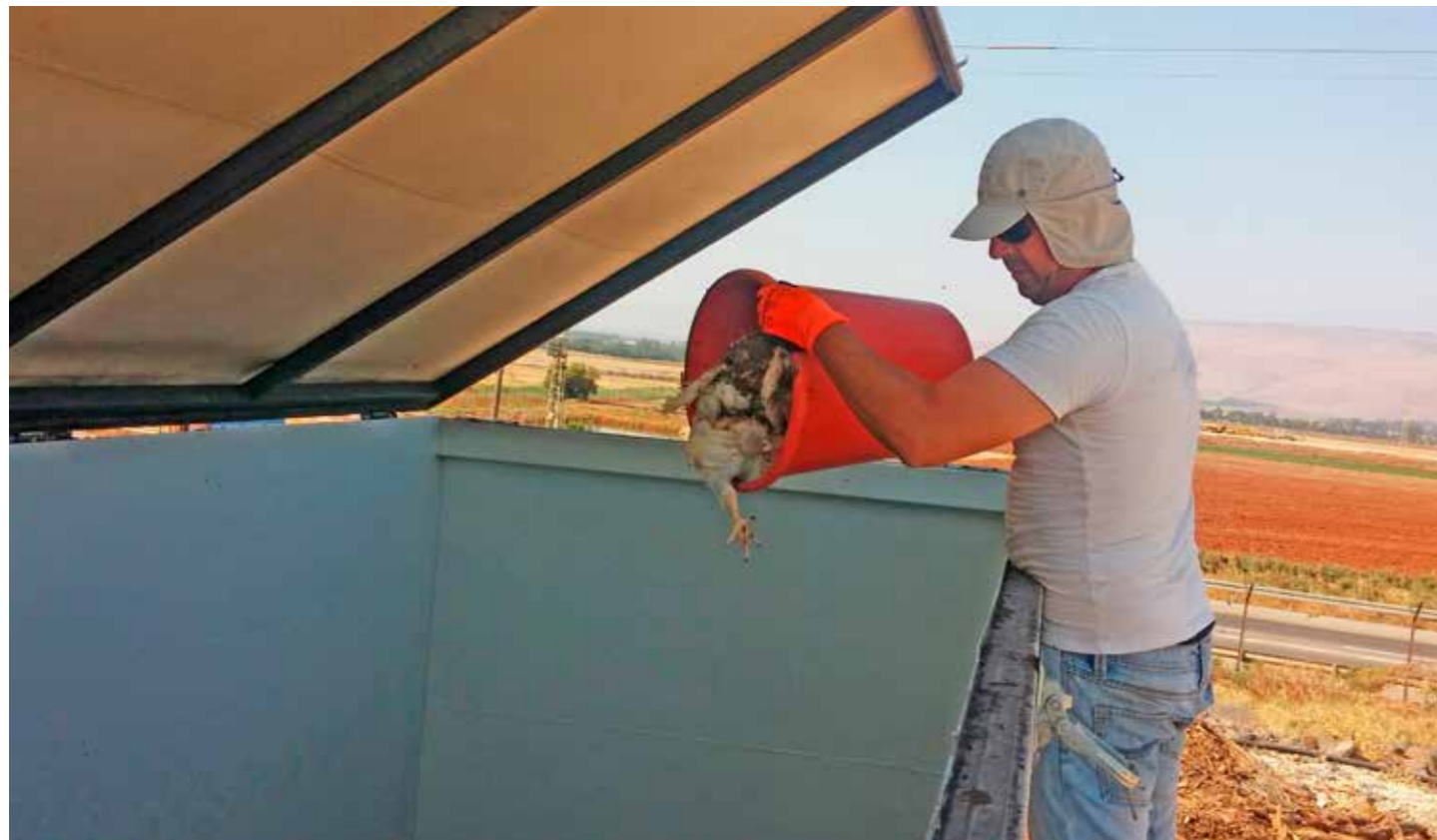
Schlachtabfälle wurden im geschlossenen CSC-Container verarbeitet und hygienisiert.
