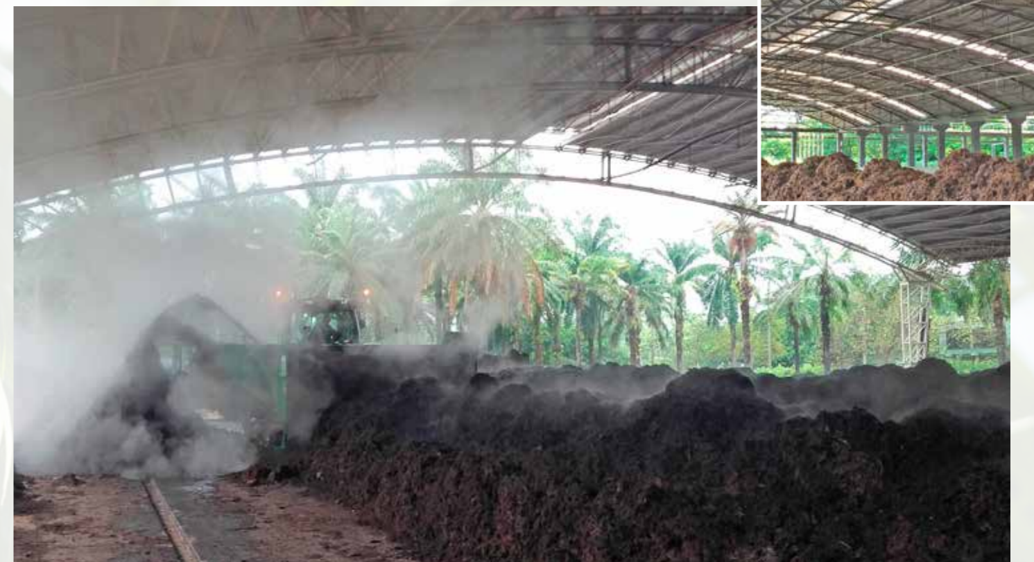
Bewässerung mittels POME-Lagune
