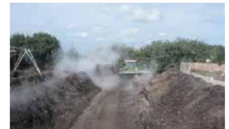
Während und nach dem Umsetzen sind die Geruchsemissionen am höchsten. Anaerobe Mieten stinken am stärksten.
