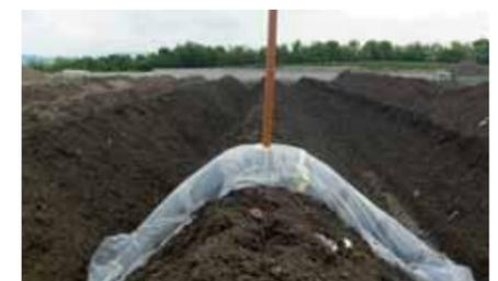
Um bei allen Witterungsbedingungen und für alle Versuchsmieten die gleichen Bedingungen zu schaffen und um die Emissionen quantifizieren zu können, wurde eine spezielle Messapparatur gebaut.
