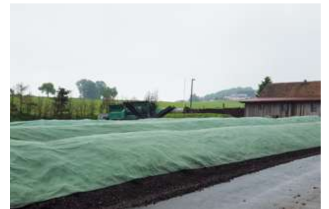
Una manta o una membrana protegen contra la lluvia y la desecación, además de reducir los olores.
