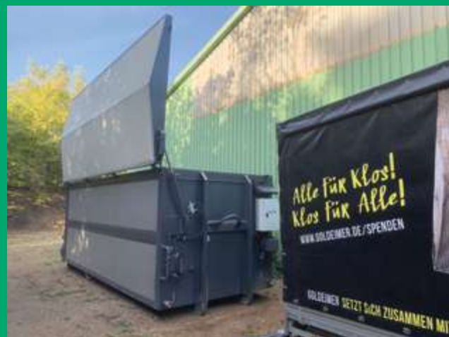
Contenedor CSC para la higienización del material.
