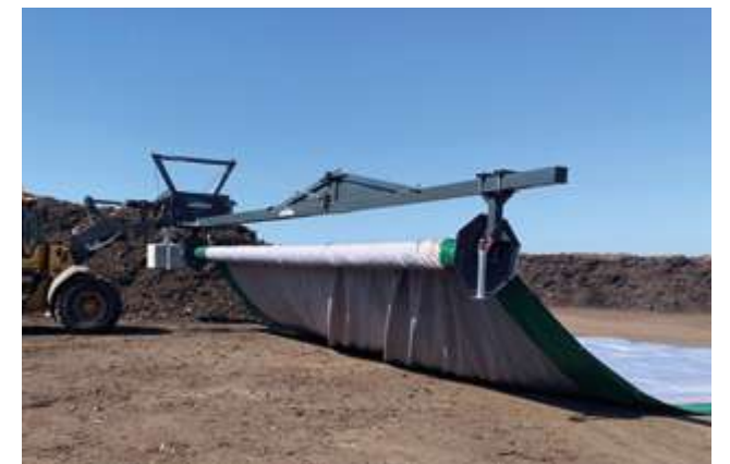
Los enrolladores de manta y membrana ayudan con la manipulación de las cubiertas de compost.
