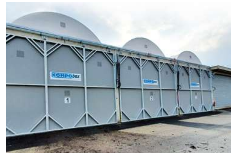
Compostaje en sistema cerrado (CSC o box) y maduración posterior.
