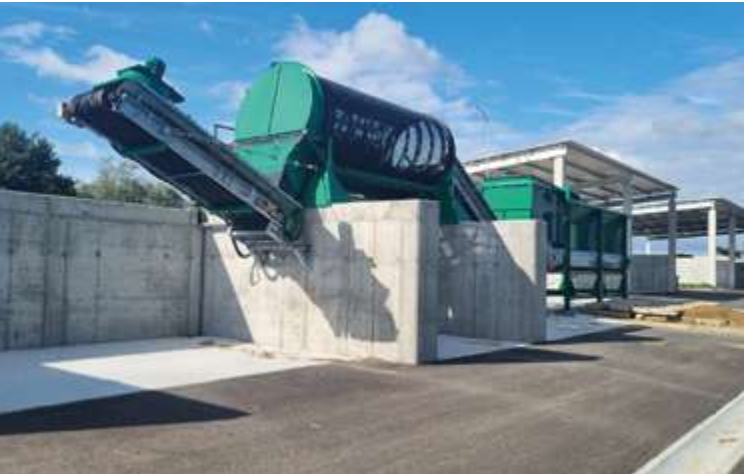
Separador de viento estacionario, incluyendo estación de tamizado.
