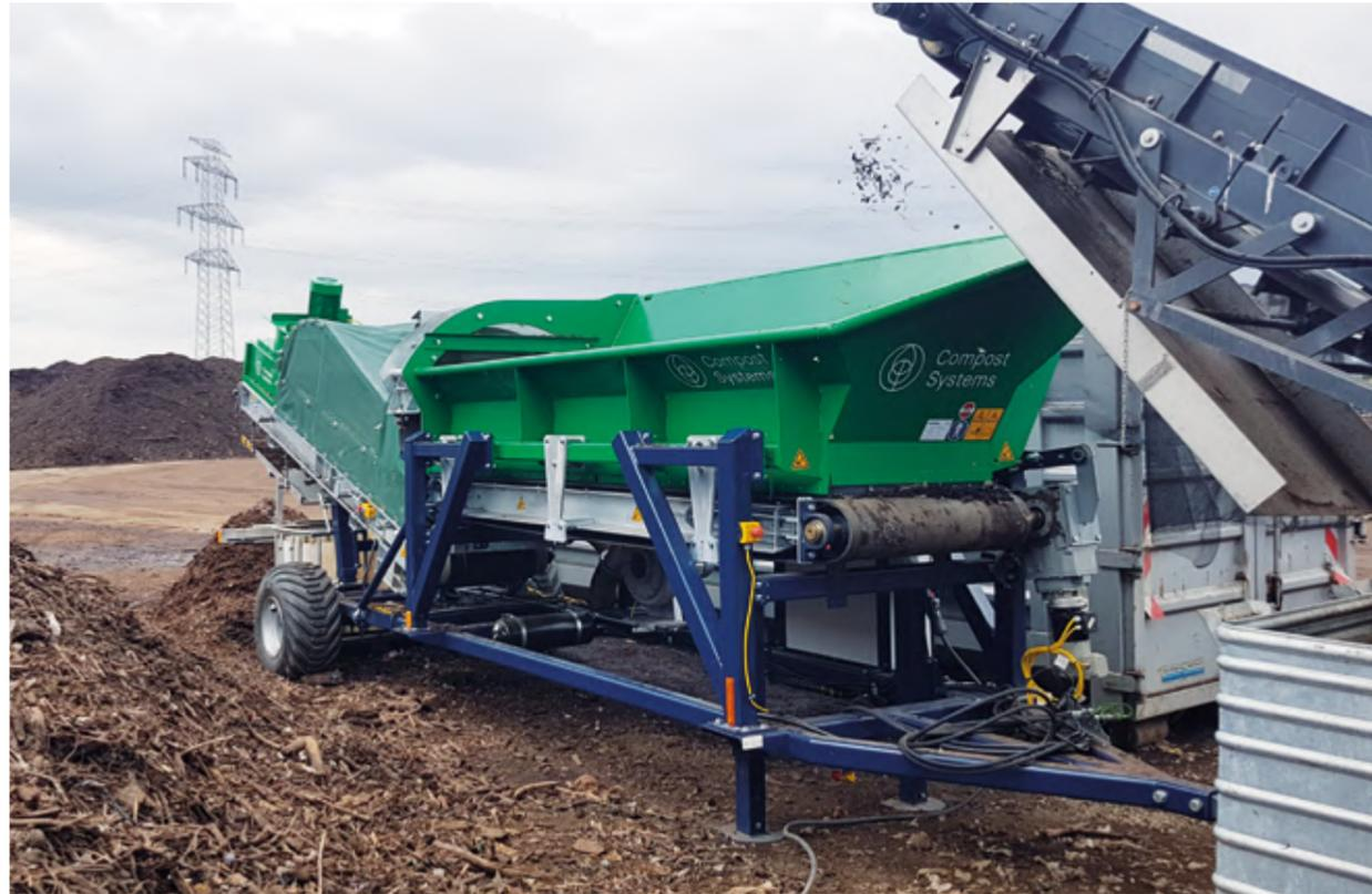
La máquina puede funcionar como solución independiente o en combinación con una criba. Es un equipo móvil que puede trasladarse de una planta a otra de forma rápida y sencilla mediante un tractor.
