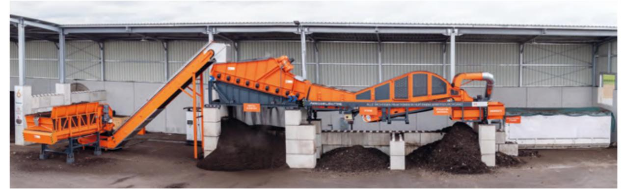
Una unidad de cribado combinada con un sistema para la eliminación de impurezas dentro del rechazo de la criba, que incluye un clasificador de aire, una trampa de piedras y un separador magnético.
