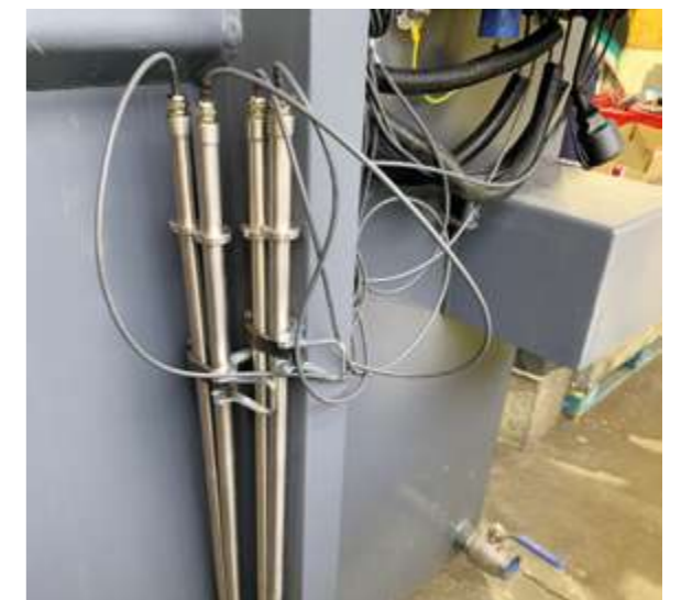
Vier Temperatur-Messlanzen gleichzeitig angeschlossen.
