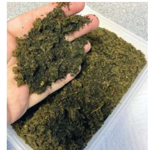
Nach 24 Stunden hat sich der Bioabfall tatsächlich in ein torf-ähnliches Produkt verwandelt. Dabei gingen ca. 42 % des Gewichts in Form von Wasser verloren. Dieser Wasserverlust wurde bei 14 % elektrischem Wirkungsgrad allerdings eher teuer erkaufte. Die Behandlung von einer Tonne Bioabfall in der Maschine kostet mehr als 700 €.
