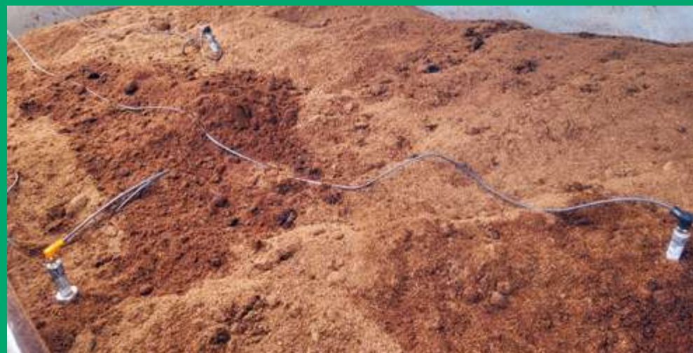
Sensorik für die kontrollierte Belüftung und den Hygienisierungsnachweis.
