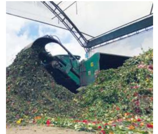
Neben dem Belüftungssystem ist auch der TracTurn Kompostumsetzer von Compost Systems auf der Anlage von Control Ambiental im Einsatz – hier beim Kompostieren von Blumen.
