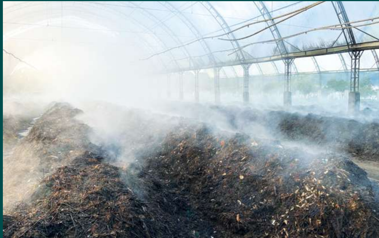
Kompostierung von Mieten unter kontrollierten Bedingungen mithilfe der Belüftungstechnologie von Compost Systems.
