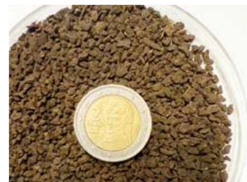
Kompost kann im Rahmen eines Herstellungsprozesses auch durchaus zu normiertem Düngergranulat oder Düngerpellets weiterverarbeitet werden. Hierbei handelt es sich um Granulat aus Pferdemit-Kompost.
