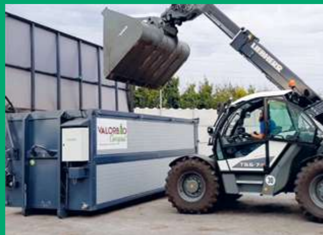
Befüllen des CSC-Containers mittels Teleskoplader.
