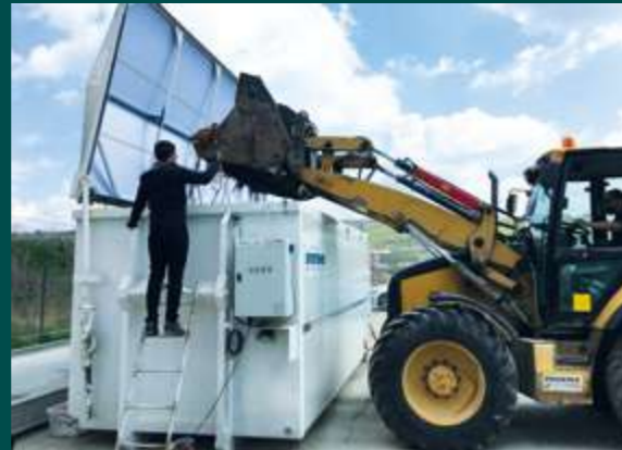
Befüllen des CSC-Containers mit Radlader.
