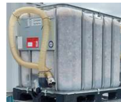
Biofilter eines CSC-Containers.
