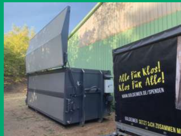
CSC-Container zur Hygenisierung des Materials.
