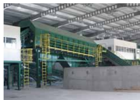
In der mechanischen Aufbereitung wird die organische Fraktion ausgeschieden und der biologischen Behandlung zugeführt.
