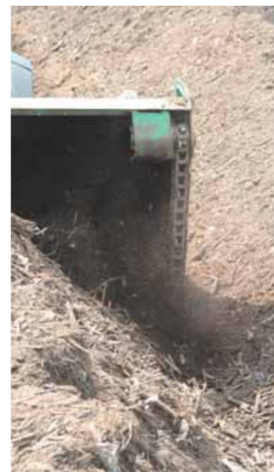
Aktive Fräßwerkzeuge für Mieten bis 2,3 m Höhe.
