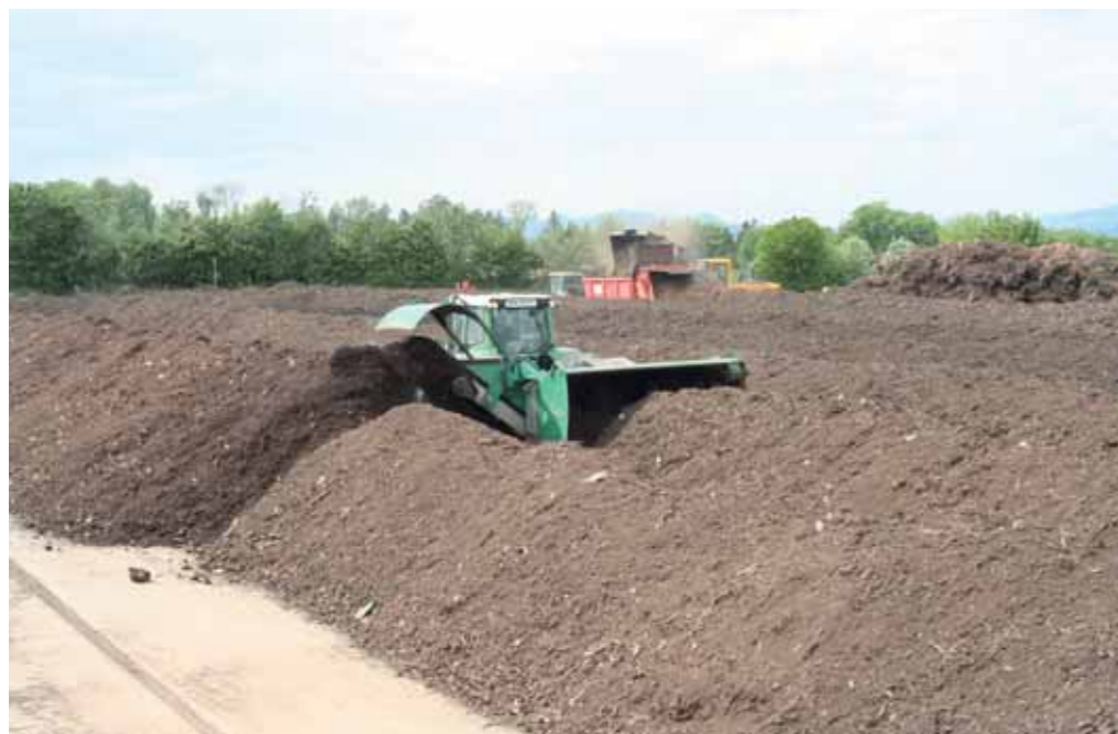
Umsetzen, Zusammenlegen, Seitenversetzen mit bis zu 3000m³/h.
