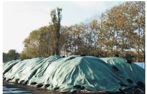
Bei offenen Mieten kann durch die Abdeckung mit Filtermembranen die Geruchsemission reduziert werden. Allerdings kein Vorteil ohne Nachteil! Die Abdeckungen müssen dicht bleiben, und sind teils schwer zu bewegen.
