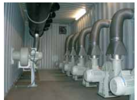
Belüftungsventilatoren im COMPotainer für Saug- oder Druckbetrieb
