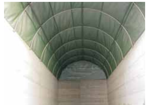
Auf dieser Anlage wurde eine COMPObox mit Membrane bespannt. Dadurch entfällt das lästige Handling.
