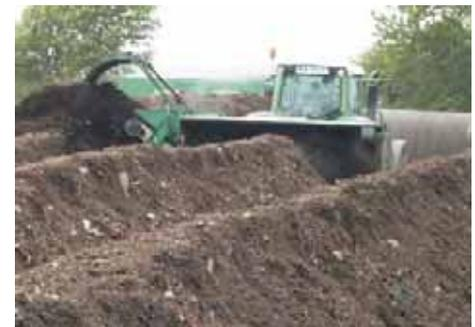
**Beim Zusammenlegen von 2 oder mehreren Mieten kann die Volumenschumpfung korrigiert oder eine Lagermiete aufgesetzt werden.**
