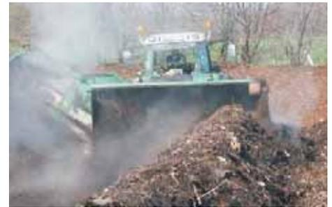
**Der TracTurn schneidet Mieten bis 2,3m Höhe einfach auseinander. Die patentierte Schrägstellung der Walze verhindert, dass der Umsetzer aus der Miete herausgedrückt wird.**
