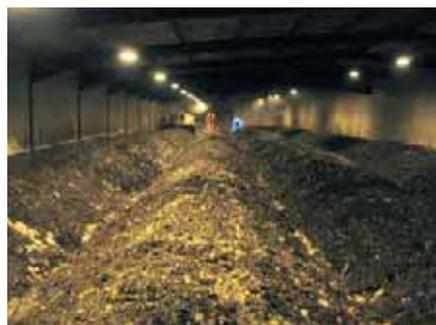
**Die Rottreaktoren sind 18m (4 Mieten) breit und 90m lang. Ein Reaktor hält gleichzeitig bis zu 1.000m<sup>3</sup> Material.**
