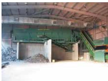
**Mit einer 20m langen Siebtrommel wird das MBA Material nach dem Zerkleinern gesiebt.**
