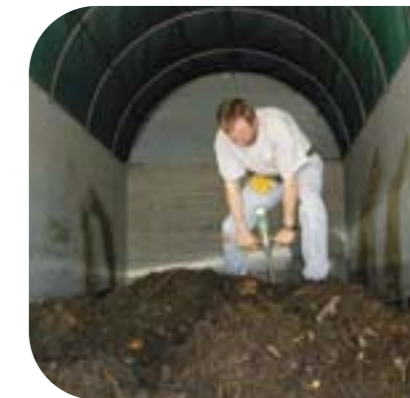
Nach dem Befüllen wird eine Funkmesslanze zur Temperaturüberwachung ins Material eingebracht. Die Temperaturen werden in bis zu 5 Zonen pro Lanze gemessen und per Funk jede Stunde an den Computer übermittelt.
