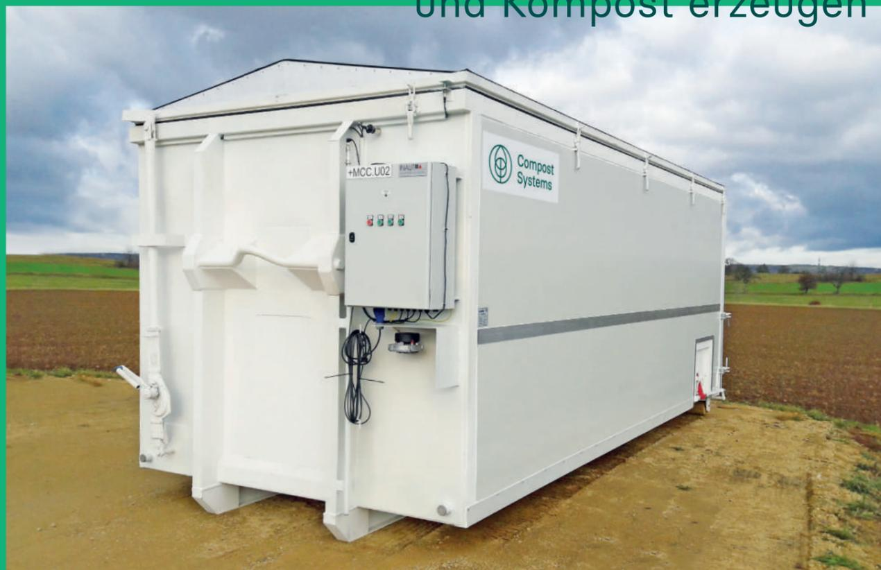
Der Deckel ist mit einer semipermeablen Membrane ausgestattet, welche einen geruchsfreien Betrieb bei geschlossenem Deckel erlaubt. Der Deckel hat eine Rundum-Dichtung und ist mittels Spannverschlüssen gesichert. Die Dreh- und Pendelklappe an der Rückseite ist wasserdicht ausgeführt und ebenfalls mit Spannverschlüssen gesichert.
